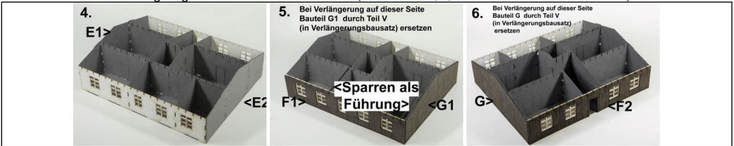
**Bauteil V ist im Verlängerungsbausatz enthalten. → Ungraviertes Bauteil G / G1**
